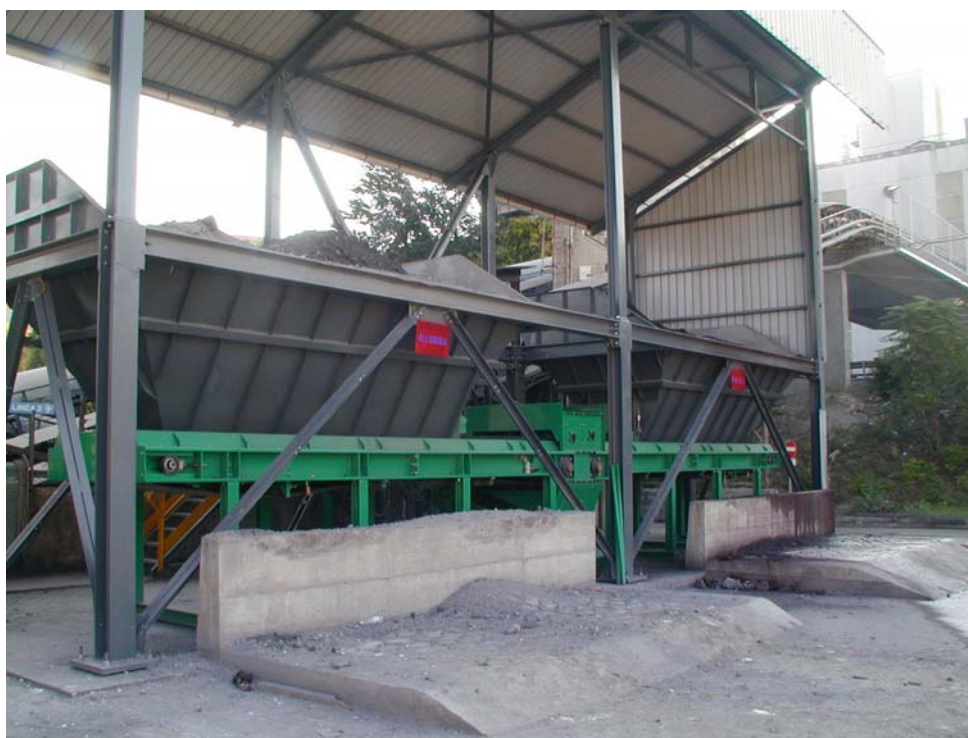
Tramogge e dosatori DPL 12-60 di carica additivi linea di macinazione molino del crudo.
