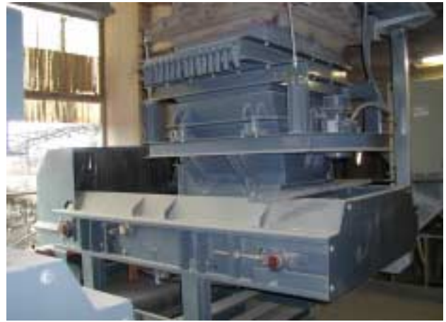
Dosatore estrattore DPL10-20 per silice, con tramoggia vibrata e nastro collettore
