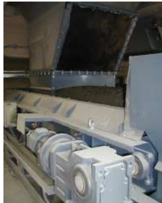
Dosatore estrattore DPL10-20 per silice, con tramoggia vibrata e nastro collettore
