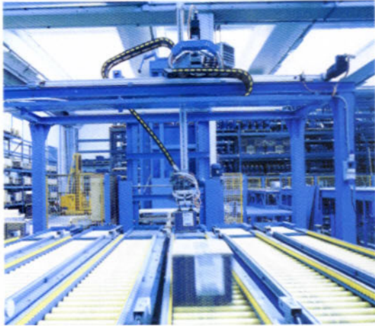
Palletizzatore di cartoni (diverse misure e pesi) Palletiser of cartons (several sizes and weights)
