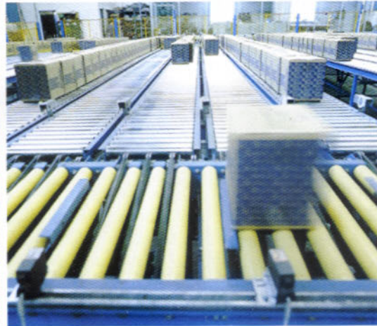
Smistatore cartoni con baie di accumulo Sorting section for cartons with buffering lanes
