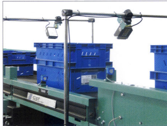
Stazione pesatura ed identificazione (barcode scanner) Identification (barcode scanners) and weighing station
